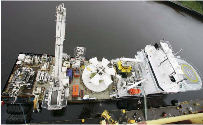
Abbildung 17: Schiff mit Unterwasser-Eingrabegeräten (Quelle: CTC)
