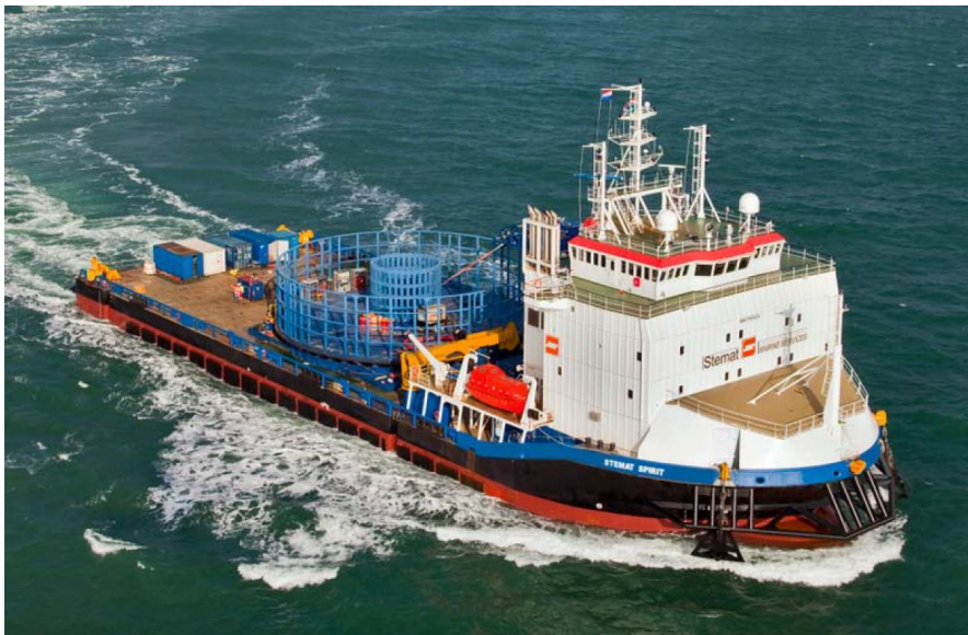
Abbildung 15: Kabelverlegeschiff Stemat Spirit (Quelle: ABB)
