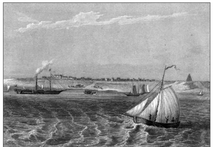
Abb. 3: Raddampfer „Telegraph“ auf der Reede vor Norderney, 1851. Erbaut in Midwall/England. Länge 37,8 m, Breite 5,2 m, 350 Passagiere. 9
